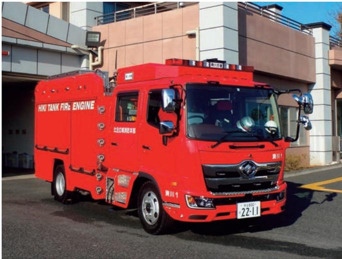
新車両は、圧縮空気泡消火装置（CAFS:キャフス）を搭載し、少ない水量で効果的に消火ができます。また、バックカメラ映像を映すデジタルインナーミラーやアドバンスモニタ（全周囲360度パノラマビュー）、自動ブレーキ装置も装備され、緊急走行時の安全性が高まりました。この車両は緊急消防援助隊の登録車両となり、県外での大規模な災害にも出動します。
